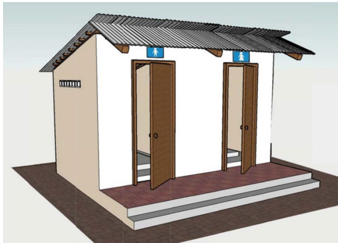
ខ. បង្គន់ចាក់ទឹក បង្ហូរទៅកាន់ធុងស្តុកទឹកស្អុយ ឬរណ្តៅ ឬកន្លែងផ្សេងទៀតដែលមិនមែនជាប្រពន្ធល
